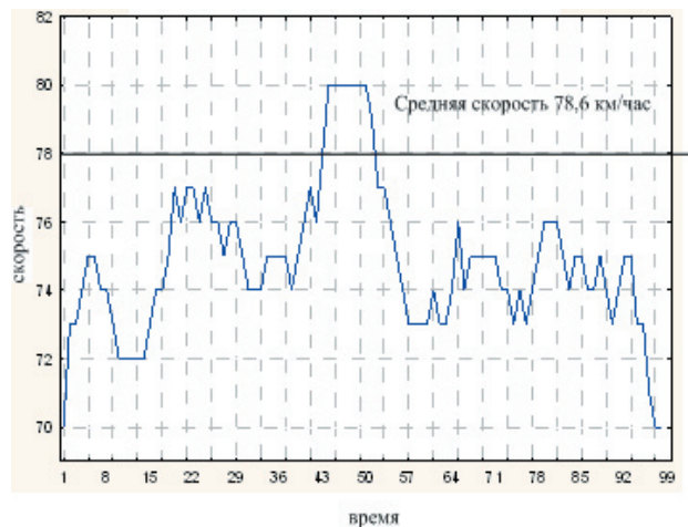
Рис. 1. Типовой городской ездовой цикл (изменение скорости движения при движении в свободном потоке с повышенной скоростью)
