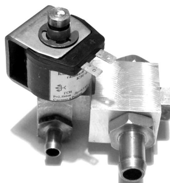
Рис.7. Внешний вид опытного образца ЭДГ для двигателя 6ГЧН 13/14
