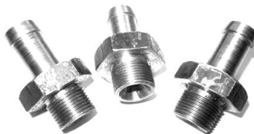
Рис.5. Внешний вид расходных жиклеров с различными диаметрами калибровочных отверстий
