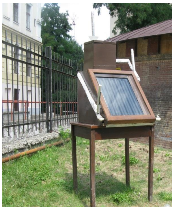
Рис. 3. Експериментальна установка: а – фото експериментальної установки; б – схема експериментальної установки; 1 – геліопокрівля; 2 – бак-акумулятор; 3 – термометри опору; 4 – джерело випромінювання; 5 – повітроспускник; 6 – патрубок сливу теплоносія; 7 – патрубок подачі води споживачу; 8 – дисплей
