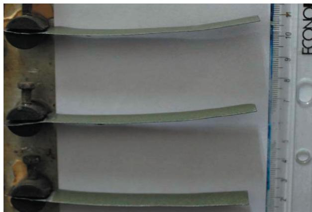
Рис. 2. Изгиб образцов с полимерными покрытиями при различных модификаторах наполнителя  $Al_2O_3$  (верхний образец – ПДЭА-4, средний образец – ПЭ-220, нижний образец – ЭД-20)
