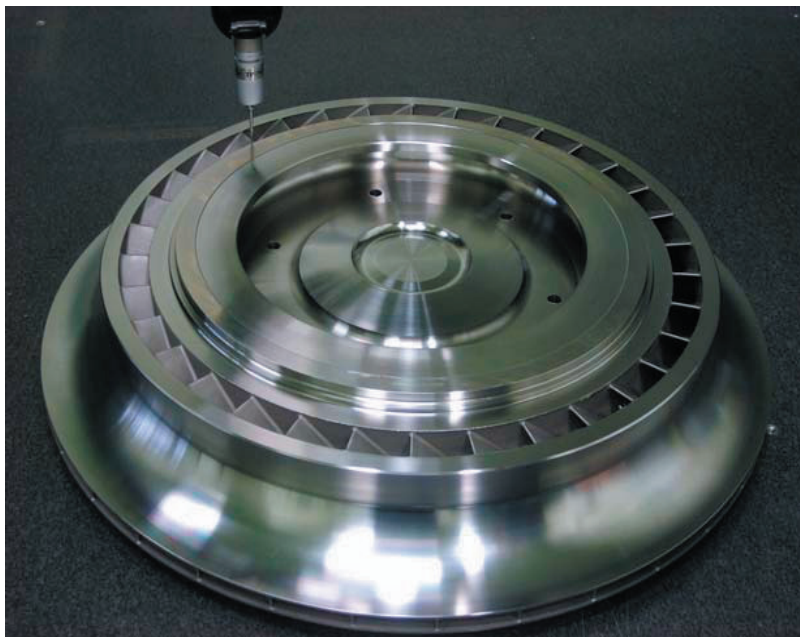
Рис. 2. Центробежное колесо «закрытого» типа, изготовленное технологией HIP
