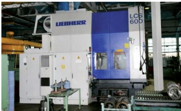
Станок модели LCS-600 предназначен для шлифования прямозубых и косозубых зубчатых шестерен методом обката и методом профильного шлифования. Станок оснащен системой управления фирмы
