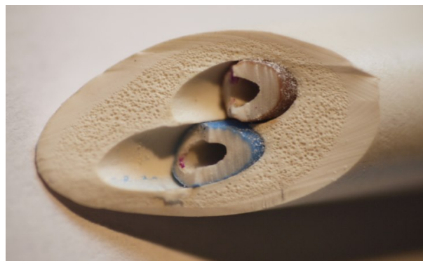
Рис. 4. Поперечний переріз кабелю з ПВХ-оболонкою за вмісту пороутворювача (Hydrocerol ВІН 70) 0,4 \%
