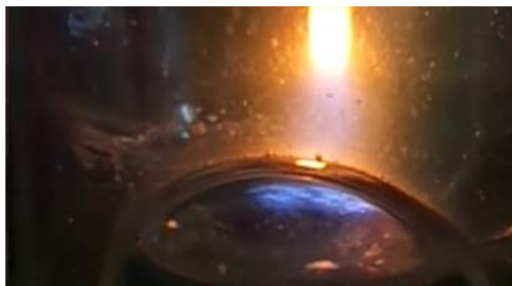
Рис. 5. Обработка раствора \text{CuSO}_4 в дистиллированной воде. C_{\text{Cu}}=0,25 г/л: а – появление соединений меди в пламени разряда; б – обычное горение разряда. Интервал между кадрами 1/20с
