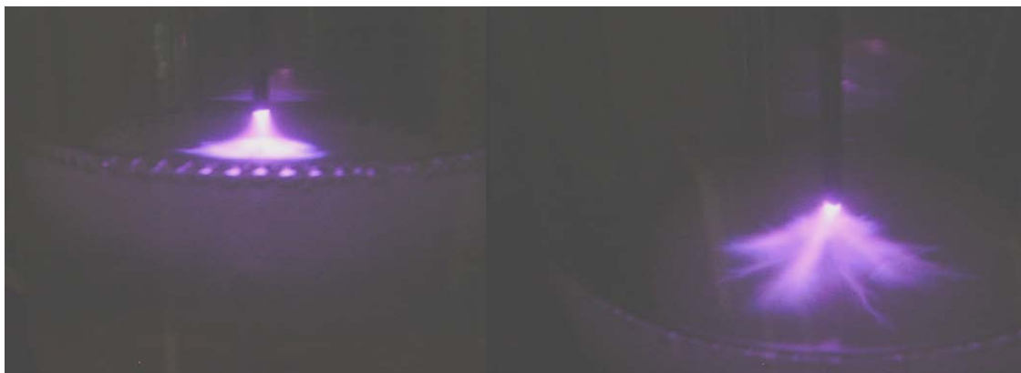
Рис. 3. Разряд при устоявшемся режиме. Вид под углом 10^\circ к поверхности жидкости. Вид под углом 45^\circ к поверхности жидкости
