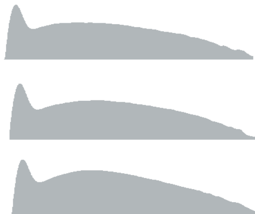
Рис. 3. Преобразование измеренных спектров в бинарные изображения
