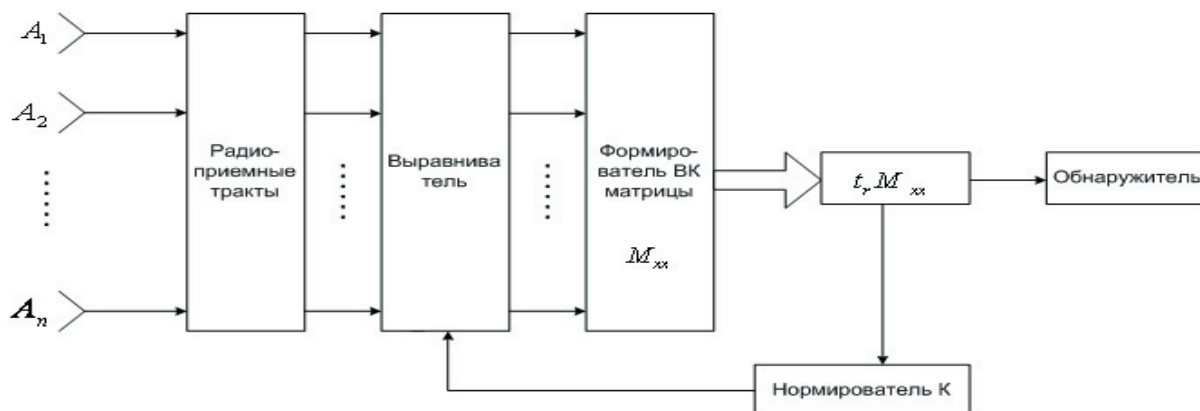
Рис. 2. Алгоритм адаптивного обнаружения и вычисления количества активных АС
