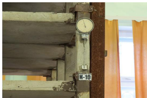
Рис. 2. Крепление индикатора к колонне
