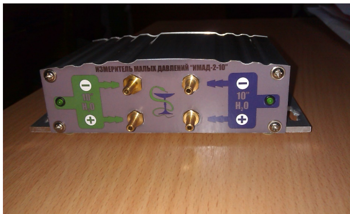
Рис. 1. Измерительный модуль программно-аппаратного комплекса «Imed»
