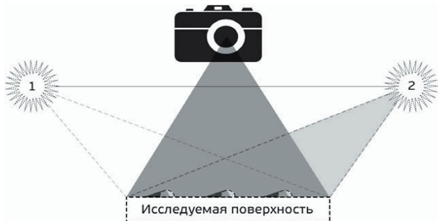
Рис. 1. Схема съемки рельефа поверхности медицинской упаковки
