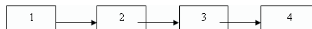
Рис. 2. Схема «сменяемых сборников»: 1) контейнерная площадка, со сменяемыми контейнерами; 2) специализированный подвижной состав; 3) средства механизации для сбора отходов; места для утилизации (захоронения) собранных отходов
