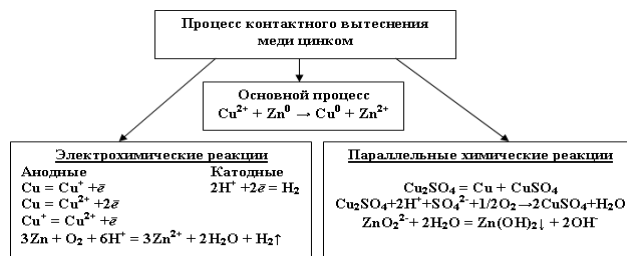
Рис. 6. Механизм контактного вытеснения меди цинком из медно-цинковых сульфатных растворов
