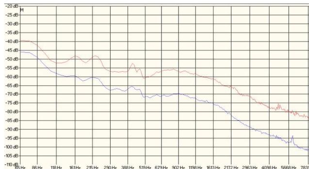
Рис. 2. Спектр транспортного шума записанного при помощи программы WaveLab
