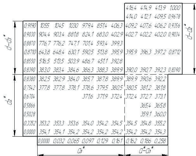
Рис. 4. Распределение температуры в электродном модуле при 50%-ном уносе утеплителя
