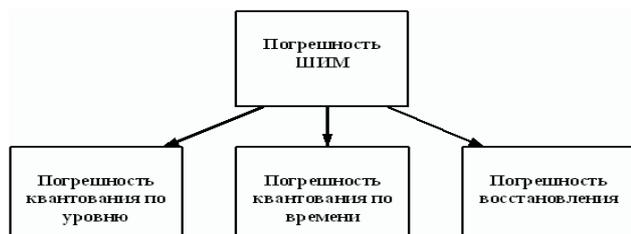
Рис. 3. Структура погрешности
