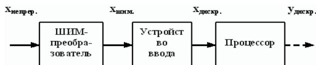
Рис. 1. Схема включения ШИМ без восстановления сигнала, где:  $x_{непер.}$  - исходный непрерывный сигнал;  $x_{шмм.}$  - модулированный сигнал;  $x_{дискр.}$  - дискретизированный по времени сигнал;  $удискр.$  - дискретизированный по времени выходной сигнал
