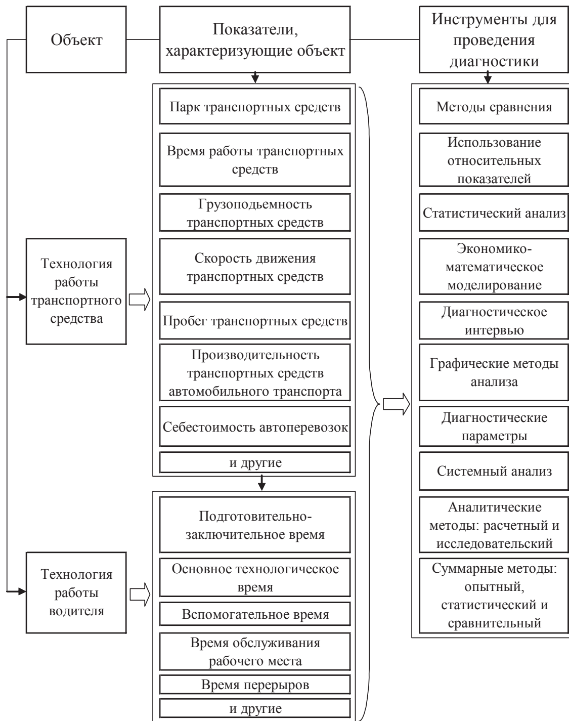
Рисунок 1. Схема взаимосвязей объекта, показателей и инструментов диагностирования работы транспортных средств и водителей
