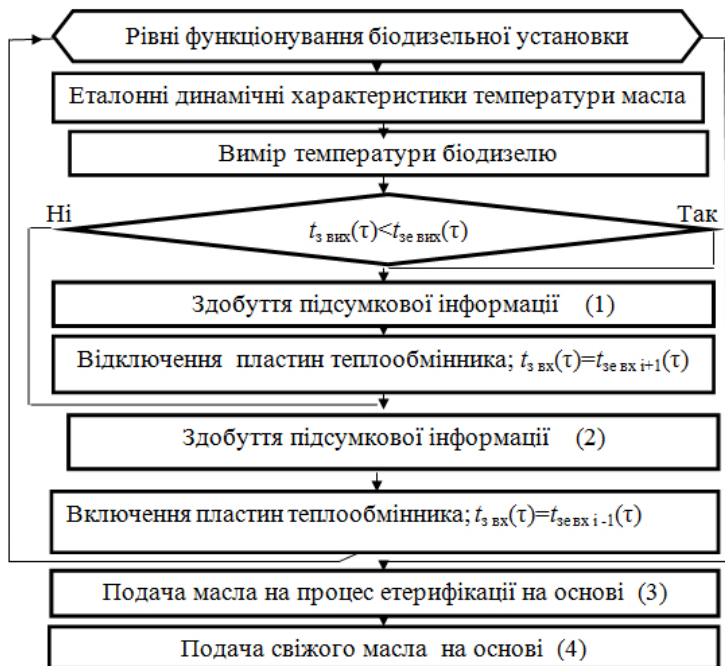
Рис. 4. Структурна схема підтримки процесу етерифікації на рівні прийняття рішень, де t_{з вх} , t_{зе вх} , t_{з вих} , t_{зе вих} – функціональна та еталонна температура біодизелю на вході в теплообмінник підігріву масла та на виході з теплообмінника, відповідно, К; i – число рівнів функціонування; \tau – час, с
