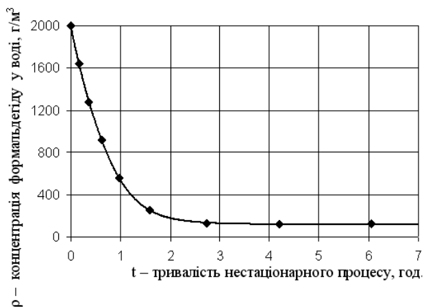
Рис. 6. Вплив тривалості нестационарного процесу на концентрацію формальдегіду у заповнюваній ємності (початкова концентрація формальдегіду \rho_0=2000 г/м 3 , умовний час початкового заповнення t_0=1 год., початкова концентрація біомаси у заповнюваній ємності \mu_0=7,5 г/дм 3 , концентрація формальдегіду у воді, що надходить, \rho_g=1000 г/м 3 ); крива – розрахунки із великим числом інтервалів
