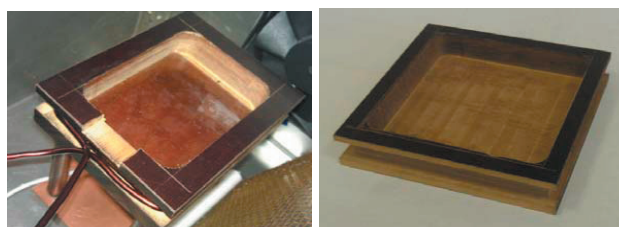
Рис. 5. Полеобразующая система (рисунок справа - рабочая камера, рассчитанная под SSD)
