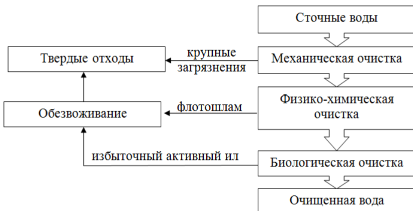
Рис. 1. Общая поэтапная схема очистки сточных вод
