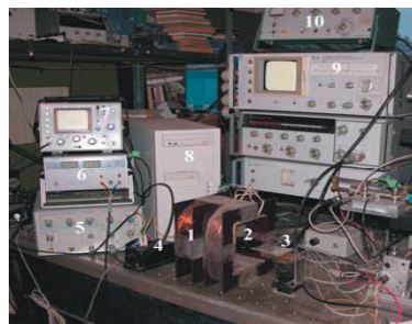
Рис. 12. Фотография стенда для исследования воздействия импульсными электромагнитными полями на структуру магнитных носителей информации: 1 - соленоид (катушки Гельмгольца), 2 - исследуемый образец, 3 - устройство позиционирования образца, 4 - электронный ключ, 5 - импульсный генератор с рабочей частотой в диапазоне от 0,1 до 20 кГц, 6 - источник питания, 7 - осциллограф, 8 - персональный компьютер, 9 - измеритель комплексного импеданса, 10 - измеритель магнитной индукции
