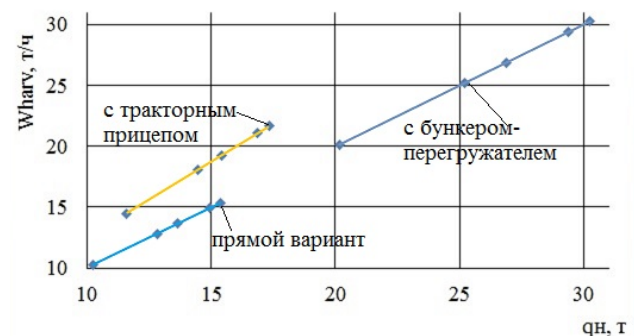
Рис. 2. Зависимость ряда грузоподъемностей автомобилей от часовой производительности комбайна
