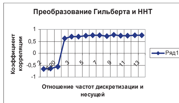
Рис. 3. Зависимость коэффициента корреляции от отношения f_d / f_0 , \sigma = 0.5
