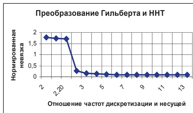
Рис. 4. Зависимость нормированной «невязки» от отношения f_d / f_0 , \sigma = 0.5
