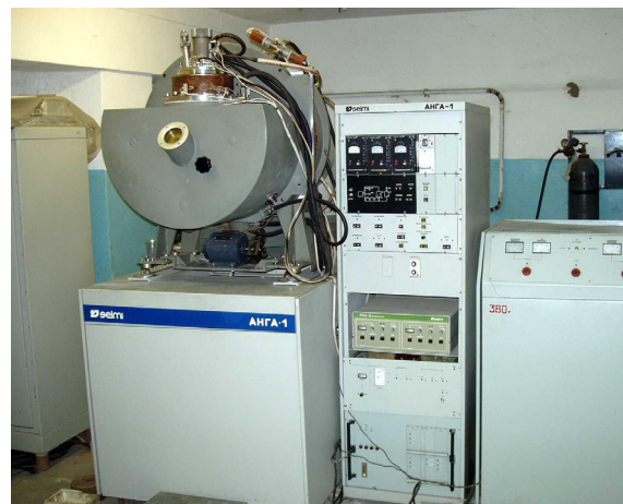
Рис. 1. Загальний вид установки АНГА-1 для вакуумно-дугового наплення покриттів
