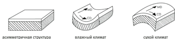
Рис. 3. Деформація картону в різних умовах
