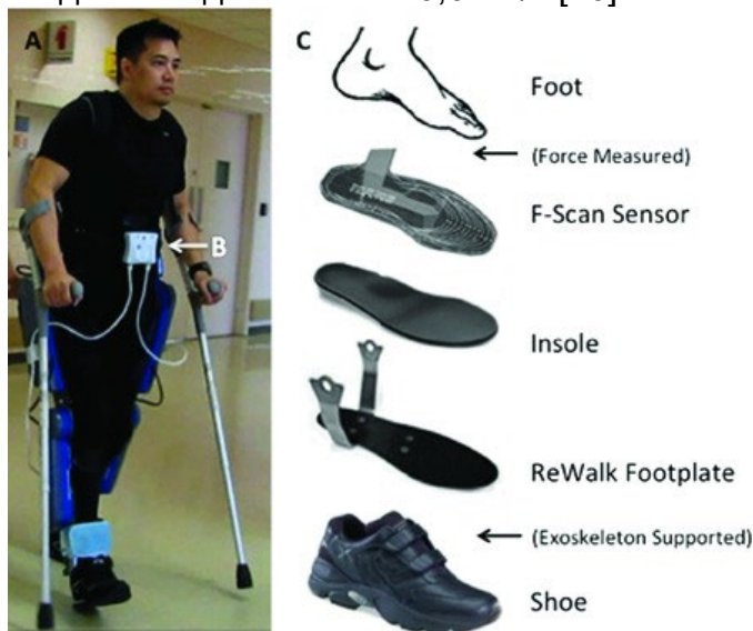
Рис. 5. Проведення біомеханічного дослідження ходьби у ReWalk за допомогою F-Scan сенсорів: А – користувач ReWalk; В – F-Scan сенсори вбудовані в систему ReWalk; С – Підшовний; F-Scan сенсори тиску
