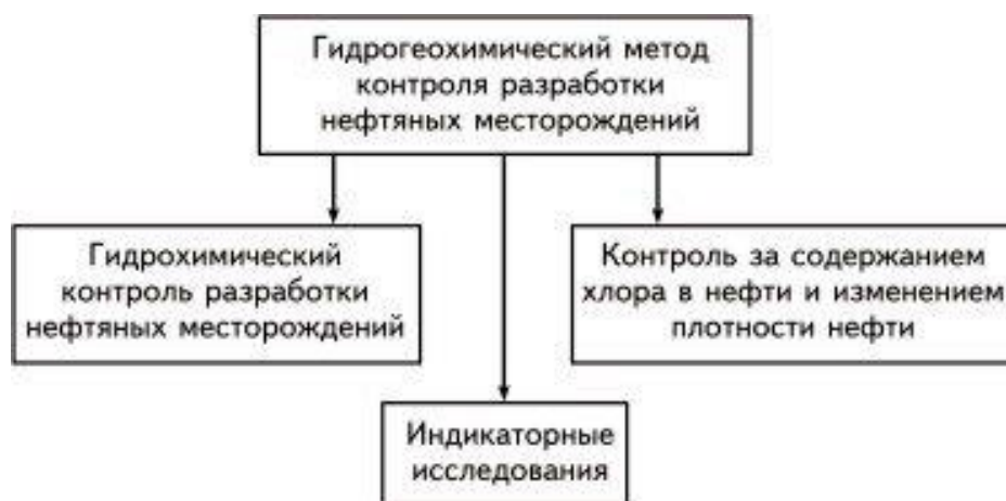
Рис. 1. Структура гидрогеохимического метода контроля разработки нефтяных месторождений
