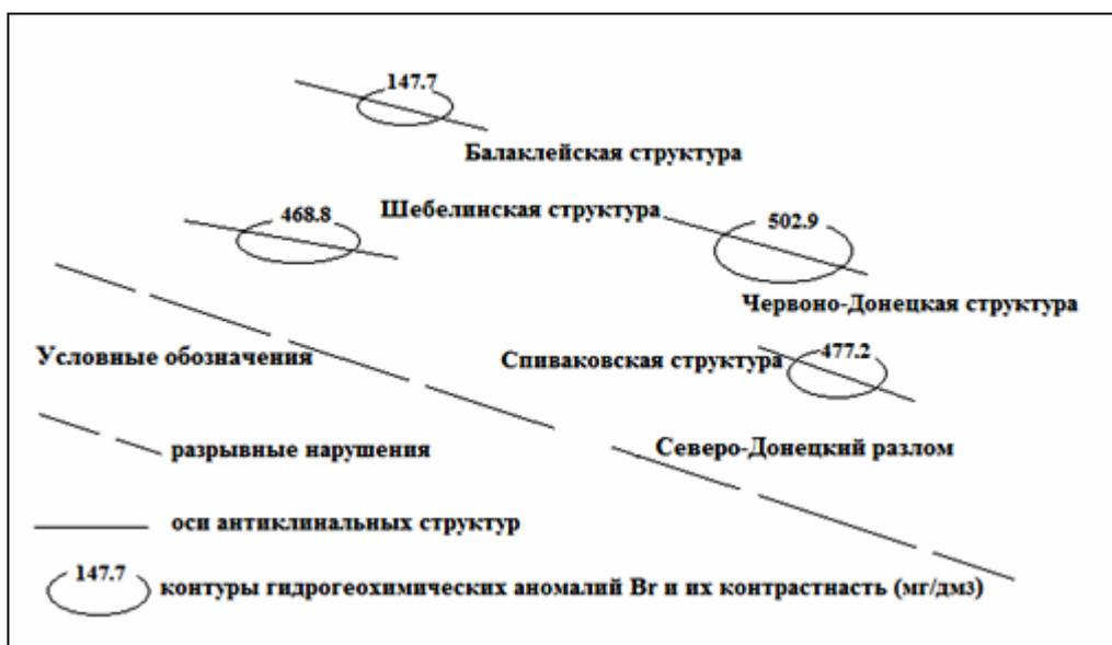
Рис. 1. Схема разгрузки бромных вод
