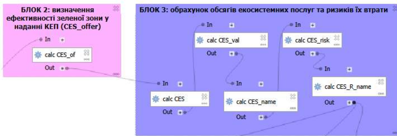
Рис. 2. Фрагмент алгоритму обчислень Model_CES: Блоки 2-3 визначення ефективності зеленої зони у наданні КЕП та обрахунків обсягів КЕП та ризиків їх втрати /
