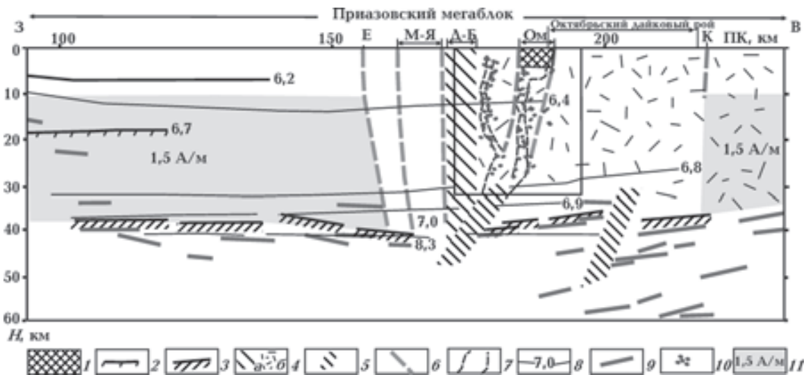
Рис. 4. Фрагмент сейсмического разреза земной коры по профилю ГСЗ Таганрог—Кировоград, по данным [Соллогуб, Трипольский, 1969]: 1 — Октябрьский щелочной массив (Ом), 2 — разлом Конрада, 3 — поверхность раздела Мохо, 4 — трасрегиональная шовная зона Донецк—Брянск (а — левая сторона, б — глубинная часть), 5 — главные глубинные разломы, 6 — главные зоны разломов (К — Кальмиусская, М-Я — Малоянисольская, Е — Екатериновская), 7 — ограничения зон тектонических нарушений (подводящих каналов) Октябрьского щелочного массива (из врезки разреза земной коры Октябрьского щелочного массива по данным метода РНП, по данным [Соллогуб и др., 1970]), 8 — преломляющиеся границы с указанием значений граничной скорости, км/с, 9 — отражающие площадки, 10 — отражающие площадки по данным РНП, 11 — проекция глубинного магнитного источника на поверхность кристаллического фундамента.
