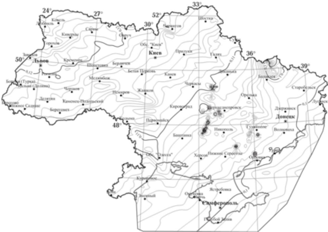
Рис. 4. Карта векового хода магнитного склонения на территории Украины за период 2010—2015 гг. Изопоры  $\Delta D$  в град/год.
