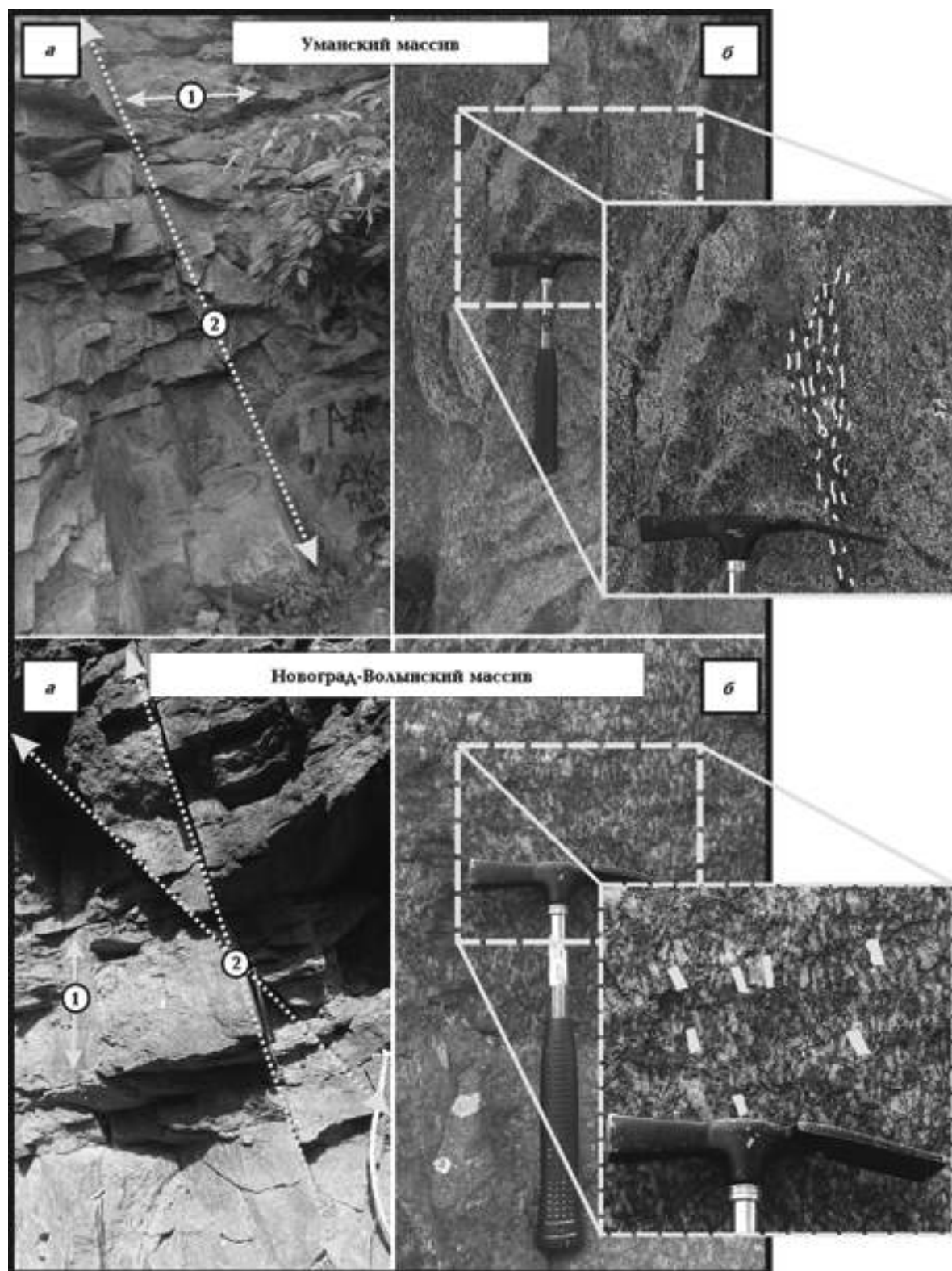
Рис. 2. Деформационные структуры в гранитоидах Уманского ( а — трещиноватость, б — линейность) и Новоград-Волынского ( а — трещиноватость, б — трахитоидность) массивов (1 — во время остывания, 2 — молодая трещина).
