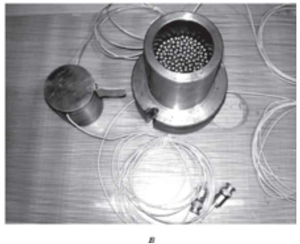
Рис. 1. Експериментальний стенд для дослідження деформування гранульованого середовища під дією імпульсного навантаження: а — загальний вигляд; б, в — циліндр і поршень. Пояснення див. у тексті.
