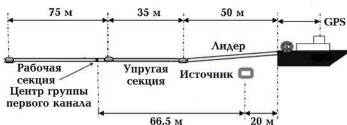
Рис. 9. Методическая схема размещения забортного оборудования сейсмического комплекса.
