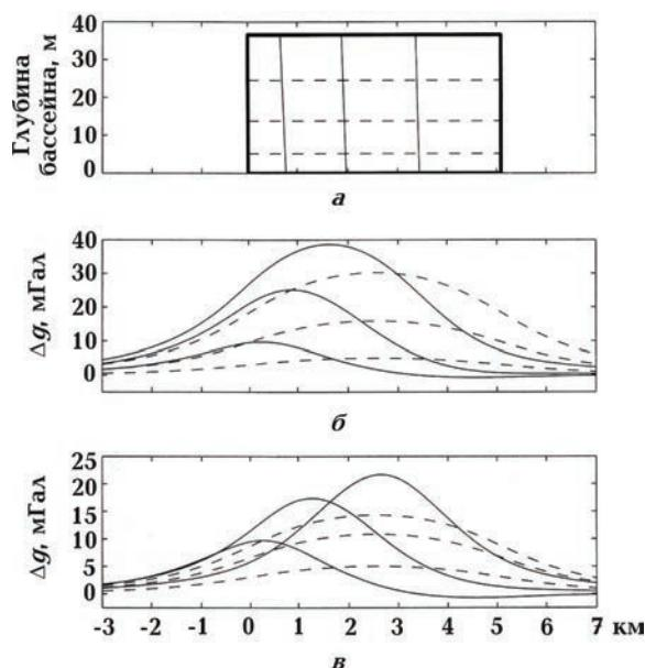
Рис. 4. Разрез бассейна с речными уровнями воды и соответствующие вариации силы тяжести.
