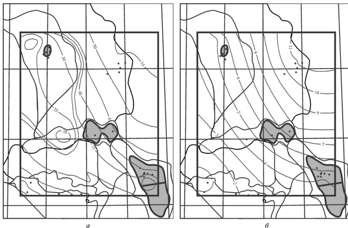
Рис. 8. Схематические карты распределения плотности ресурсов газа (а) и нефти (б) для палеозойского НГК и нижнеюрского подкомплекса юрского НГК. Изолинии — плотность первично-аккумуляированных ресурсов газа (нефти), тыс. т/км 2 .
