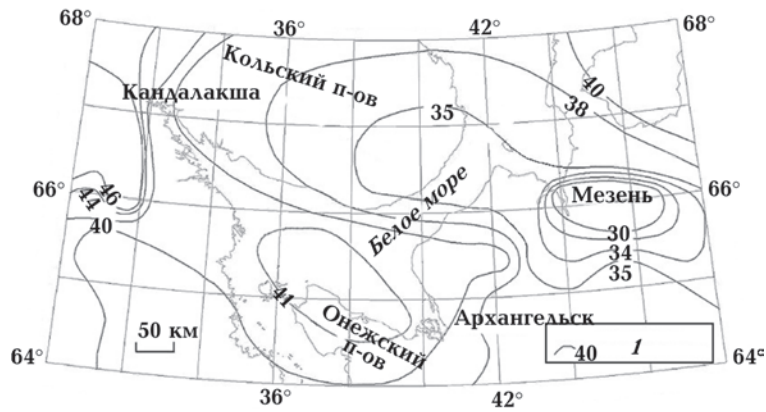
Рис. 7. Схема мощности земной коры по сейсмическим данным.
