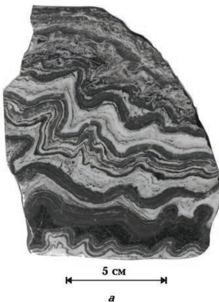
Рис. 1. Зависимость складчатости продольного изгиба от мощности компетентного слоя: а — дисгармоничная мелкая складчатость в образце барит-сфалеритовой руды, претерпевшей контактовый динамометаморфизм (по Г.Б.Паталаха); б — соотношение мощности слоя и длины волны природных складок (1 — по данным [Currie et al., 1962], 2 — на основании обработки опубликованных материалов Е.И.Паталахи, Г.Б.Паталаха, В.И.Громин, В.А.Лукьянова (см. Приложение)). Показаны изолинии равных значений безразмерного напряжения \sigma/E .
