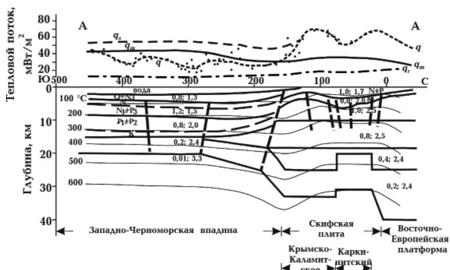
Рис. 3. Тепловые потоки и геотермическая модель земной коры вдоль профиля ГС3-25 [Кутас, 2011].
