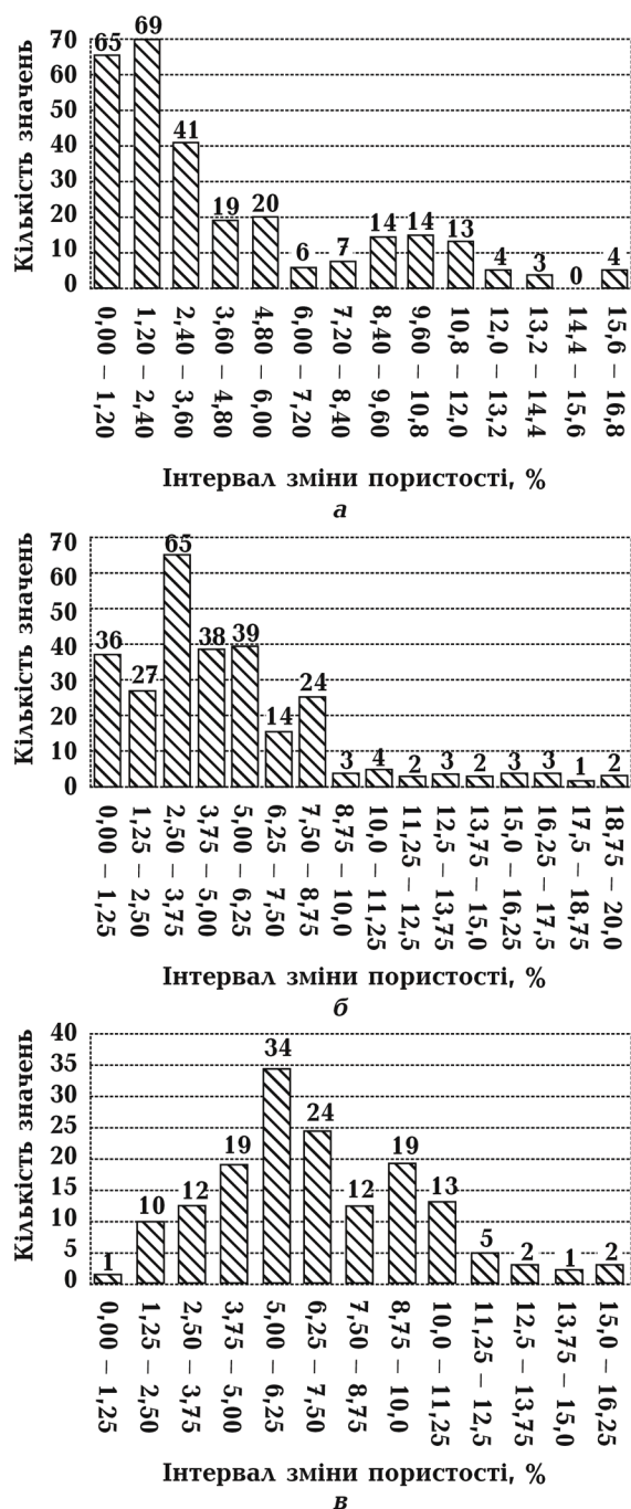
Рис. 1. Результати петрофізичних визначень пористості згідно з [Вижва та ін., 2012]: а — бімодальний з максимумом у капілярах і мікропорах, б — унімодальний неоднаковий з максимумом у менших капілярних порах, в — унімодальний рівномірний з максимумом у великих капілярних порах.
