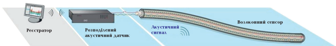
Рис. 2. Система реєстрації акустичних коливань з використанням оптоволоконного кабелю DAS ( https://www.apsensing.com/publications ).
