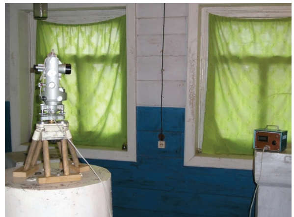
Рис. 3. DI fluxgate Tavistock з ферозондом FLM1/B.
