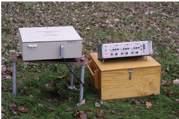
Рис. 2. Цифрова магнітоваріаційна станція PSM-8911.
