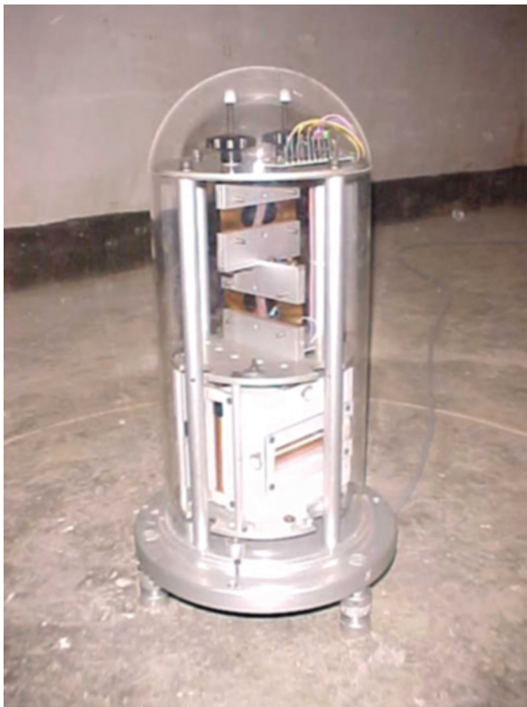
Рис. 4. Трикомпонентна магнітоваріаційна станція FGE.
