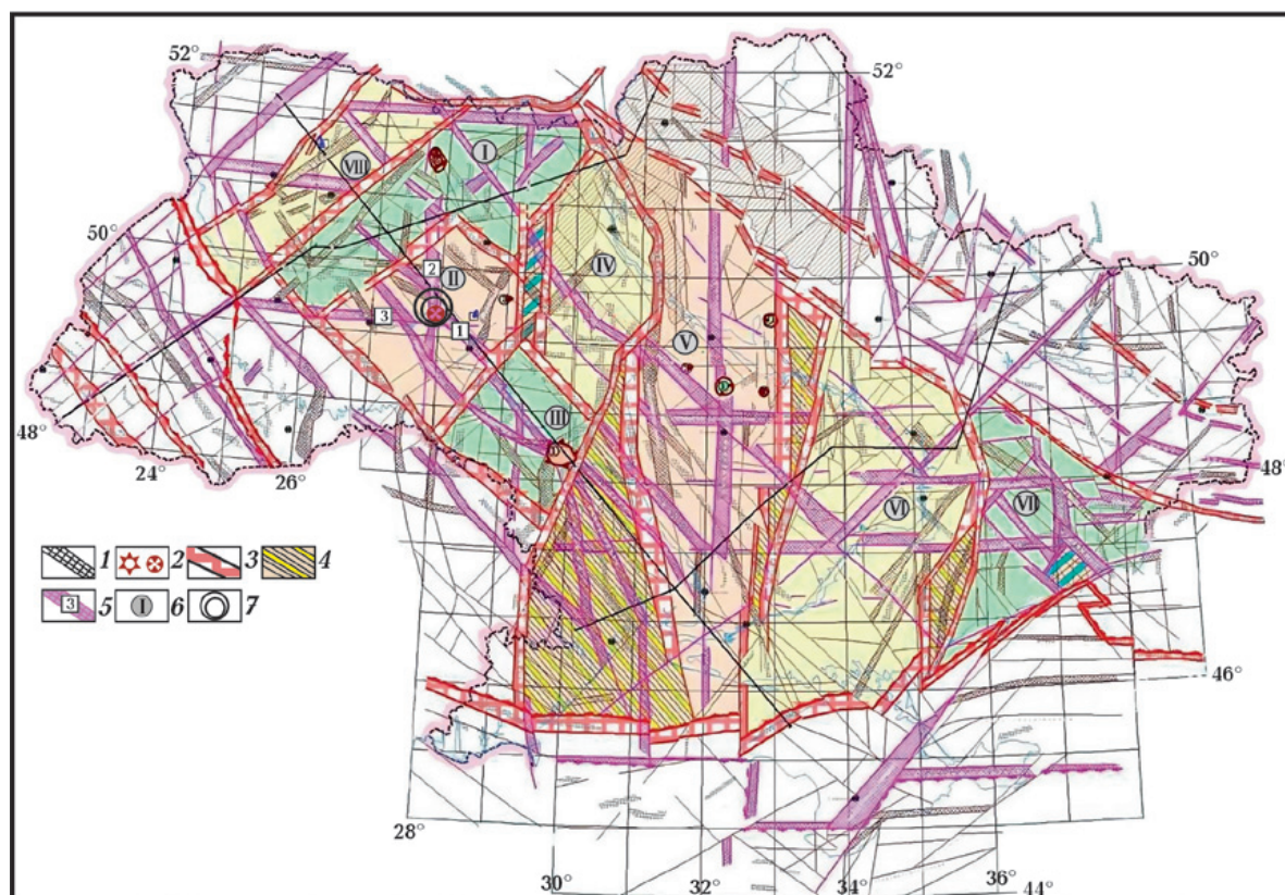
Рис. 1. Геофізична основа Тектонічної карти України, за [Єнтін та ін., 2002]: 1 — зони лінійних мінімумів \Delta q_{\text{лок}} ; 2 — локалізовані ізометричні максимуми і мінімуми \Delta q_{\text{лок}} ; 3 — глибинні міжмегаблокові зони розломів I рангу; 4 — шовні зони I та II рангу; 5 — глибинні внутрішньоблокові зони розломів II рангу; 6 — мегаблоки Українського щита (I — Волинський, II — Подільський, III — Бузький, IV — Росинський, V — Інгульський, VI — Середньопридніпровський, VII — Приазовський, VIII — Осницько-Мікашевицький вулканоплутонічний пояс); 7 — район досліджень.
