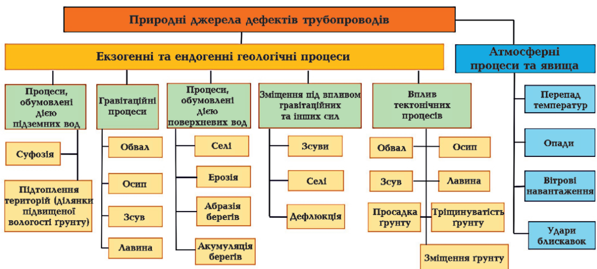
Рис. 2. Узагальнена схема впливу природних чинників на формування дефектів трубопроводів.
