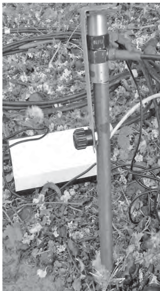
Рис. 11. Розміщення п'єзодатчика на металевому стрижні для вивчення його властивостей на глибині в ґрунті 30—40 см.
