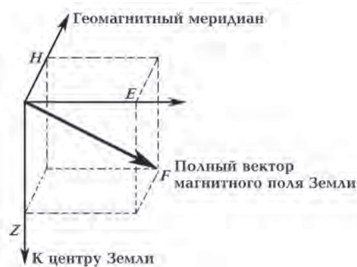
Рис. 10. Составляющие полного вектора магнитного поля Земли и их направления: F — полный вектор магнитного поля Земли, H — северная компонента, E — восточная, Z — вертикальная.
