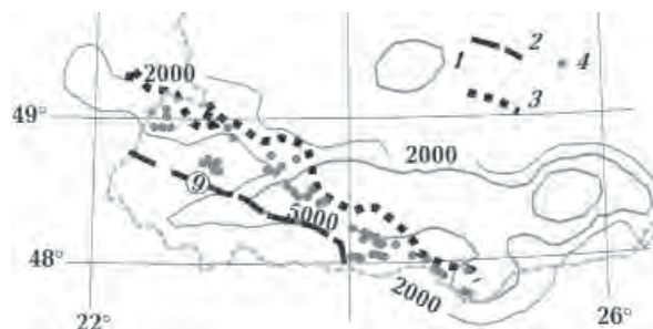
Рис. 14. Распределение проводимости, См (1), северная граница максимальной плотности геотермических ресурсов (2) (цифра в кружке — W в т.у.т./м 2 ) [Гордиенко и др., 2011]; северная граница гидротермального поля (3) и источники минеральных углекислых вод (4) [Шлапінський, 2015].
