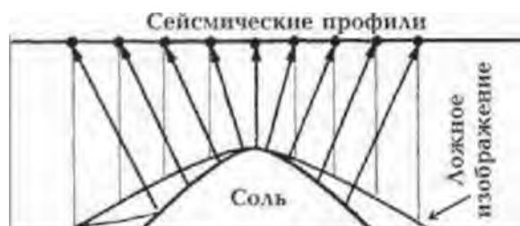
Рис. 1. Схема ложного расширения изображения соляного купола при 2D наблюдениях [Houck et al., 1996].
