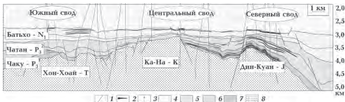
Рис. 2. Схематический продольный геологический разрез месторождения Белый Тигр: 1 — тектоническое нарушение; 2 — залежь нефти в осадочном чехле; 3 — траектория скважины; 4 — нерасчлененные отложения; 5 — отложения нижнего миоцена; 6 — отложения верхнего олигоцена; 7 — отложения нижнего олигоцена; 8 — залежь кристаллического фундамента.
