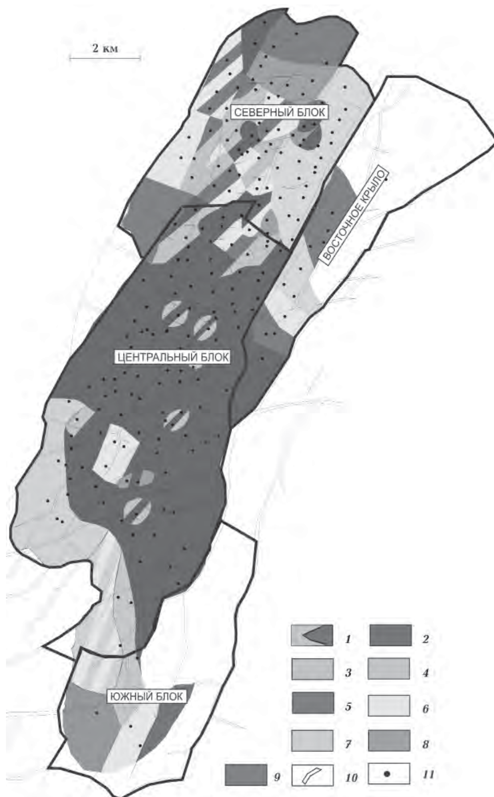
Рис. 3. Схема распространения петротипов пород кристаллического фундамента месторождения Белый Тигр: 1 — граница геологического блока; 2 — граниты; 3 — адамелит; 4 — кварцевые монзониты; 5 — гранодиориты; 6 — кварцевые биотитовые монцодиориты; 7 — кварцевые амфибол-биотитовые монцодиориты; 8 — кварцевые биотитовые диориты; 9 — амфибол-биотитовые диориты; 10 — тектоническое нарушение; 11 — скважина.
