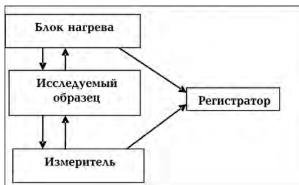
Рис. 1. Блок-схема автоматизированного комплекса измерения электрических параметров минерального вещества.
